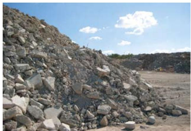
2 Betonbruch aus Plattenbauten
